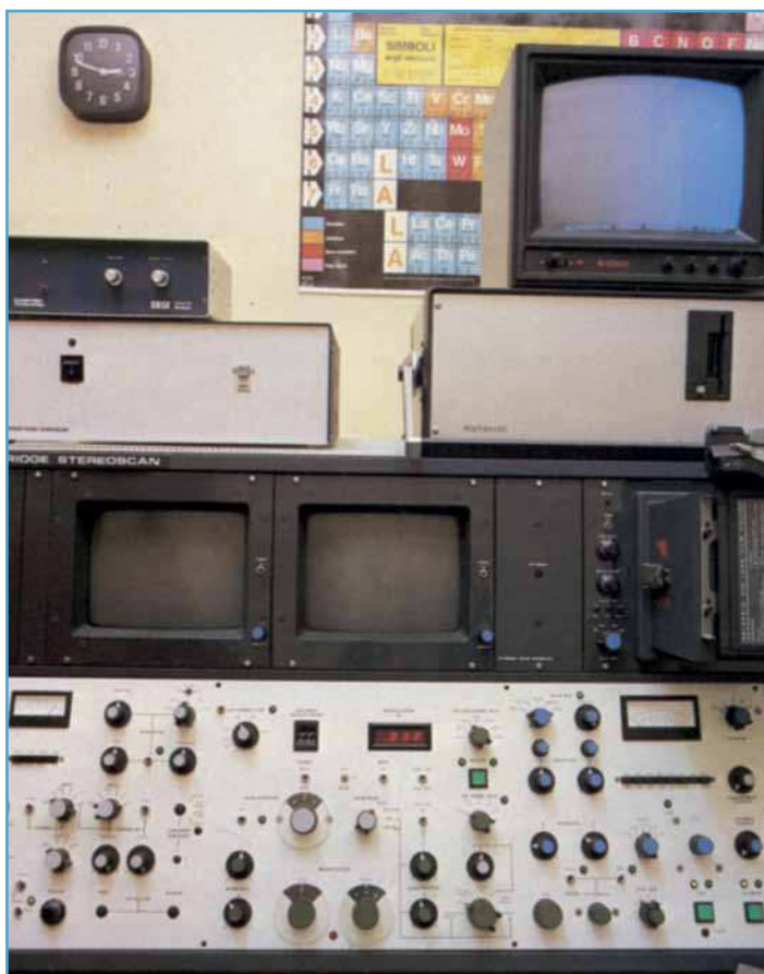
▲ Lo strumento per la ricerca delle tracce di sparo è il microscopio elettronico a scansione abbinato a una microsonda analitica a dispersione di energia (il complesso SEM/EDS o EDX), qui in un modello degli anni Settanta
