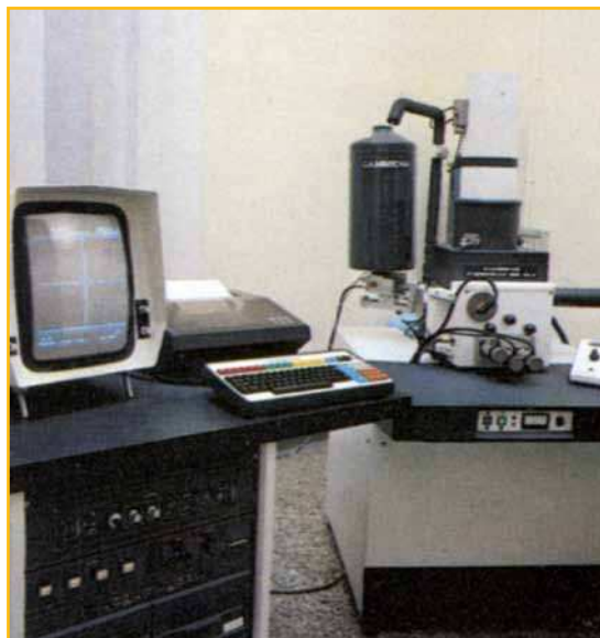
▲ Particolare di un SEM Stereoscan 250 Mk2 degli anni Ottanta: a destra il cannone elettronico con la sottostante camera portacampione del microscopio, a sinistra il computer della microsonda a dispersione di energia
